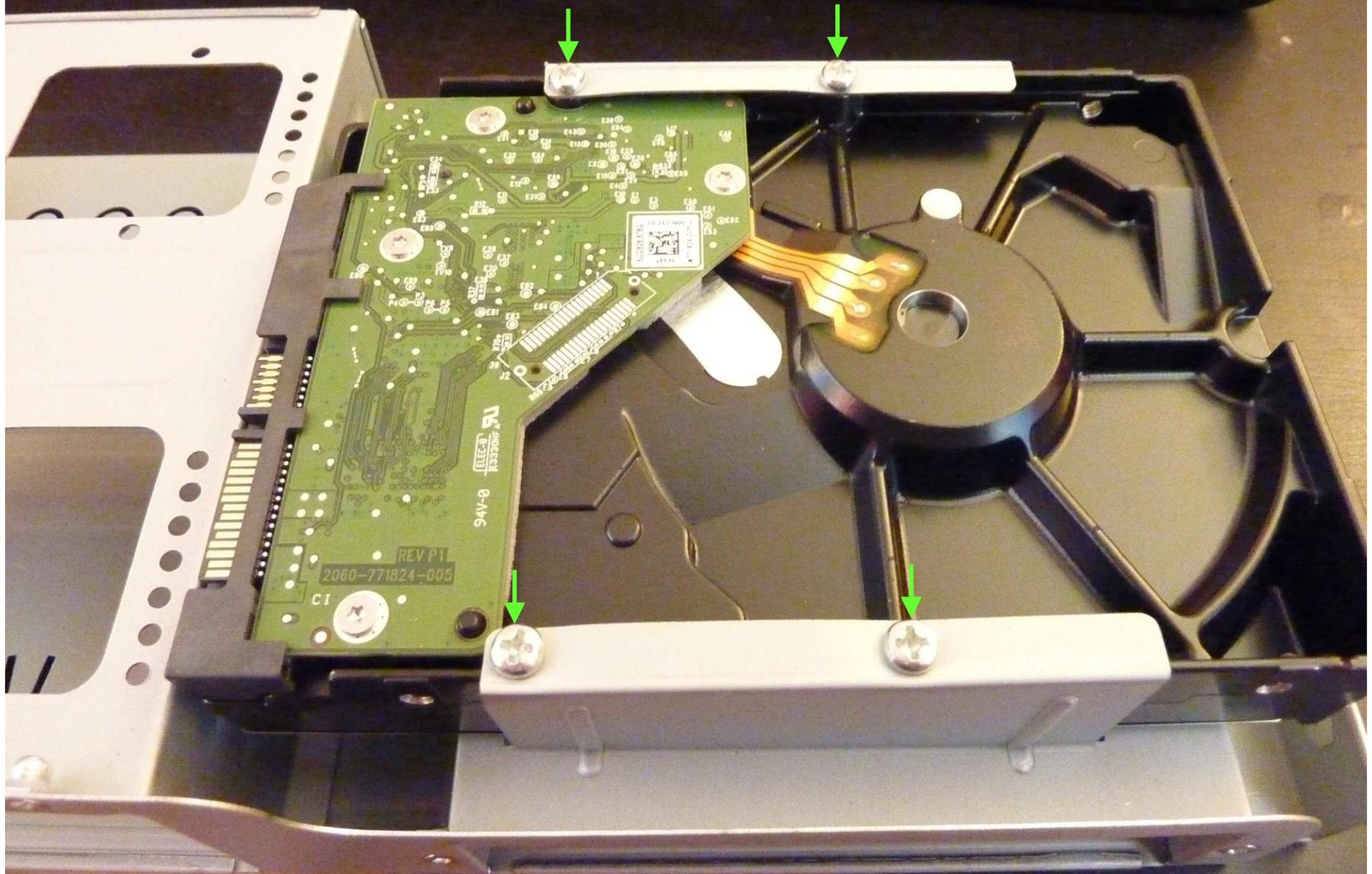
Passons au disque système. Cette cage est mal fichue dans la mesure où on ne peut utiliser que **deux vis d'un seul côté** dans le cas d'un **disque dur**, et même **une seule et unique vis** dans le cas d'un **SSD**.
