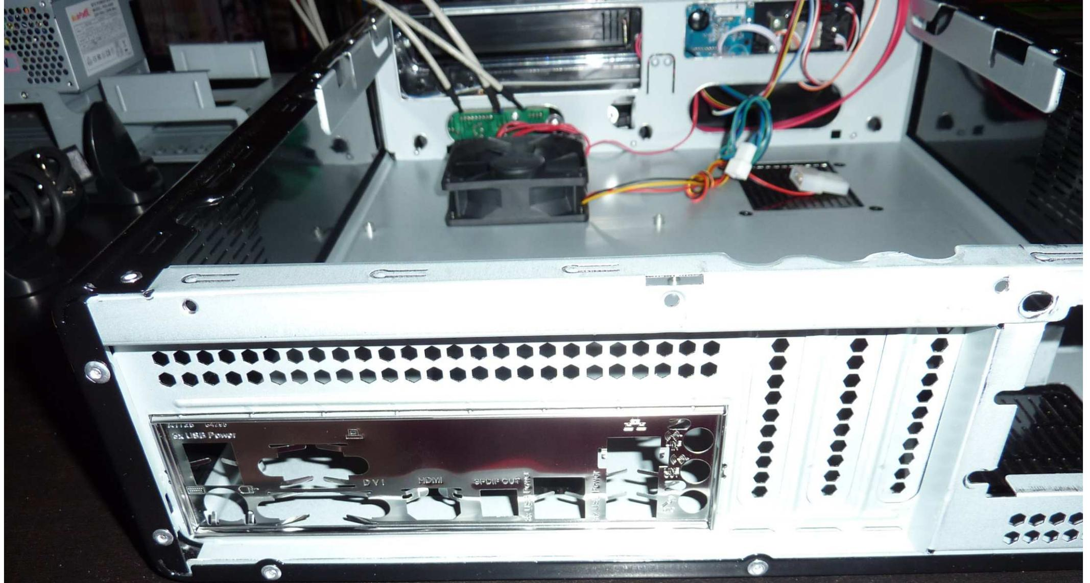
Insérez la façade arrière **par l'intérieur du boîtier**, trous pour les prises vers le bas du boîtier. Il y a un peu de jeu, mais c'est normal, la carte-mère une fois positionnée maintiendra la façade en place par rapport au boîtier.
