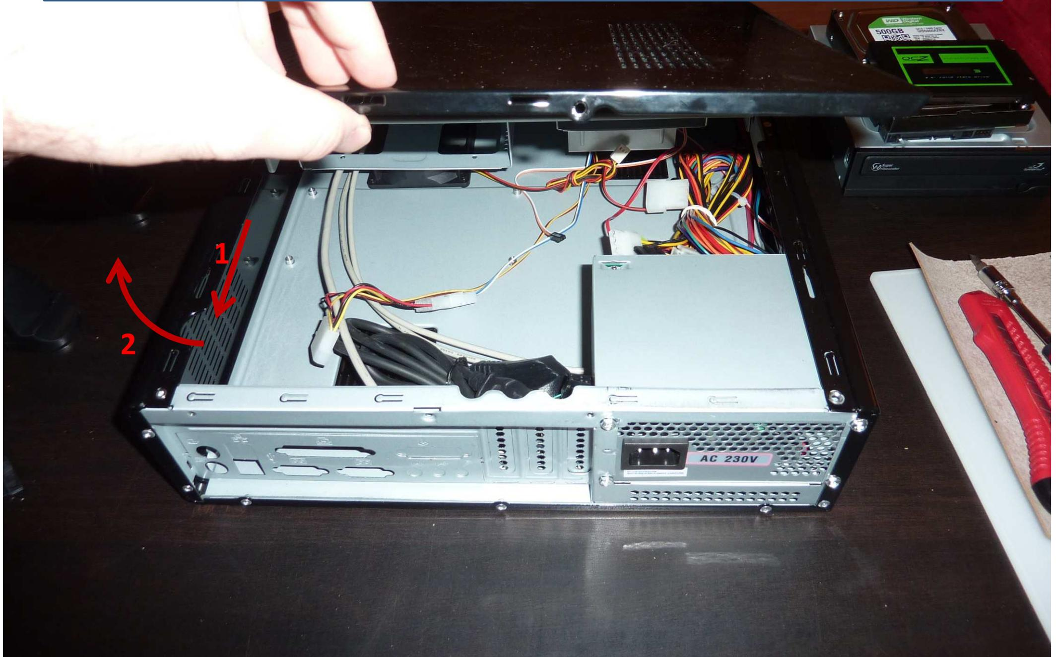
La cage métallique des lecteurs (optiques et de stockage) doit être d'abord sortie. Pour cela, levez selon les deux flèches rouges en tirant fort pour faire sortir les deux crans de positionnement de la cage. Cependant, ne montez pas trop la cage sous peine de venir cogner contre les ergots de la façade avant (flèches jaunes).
