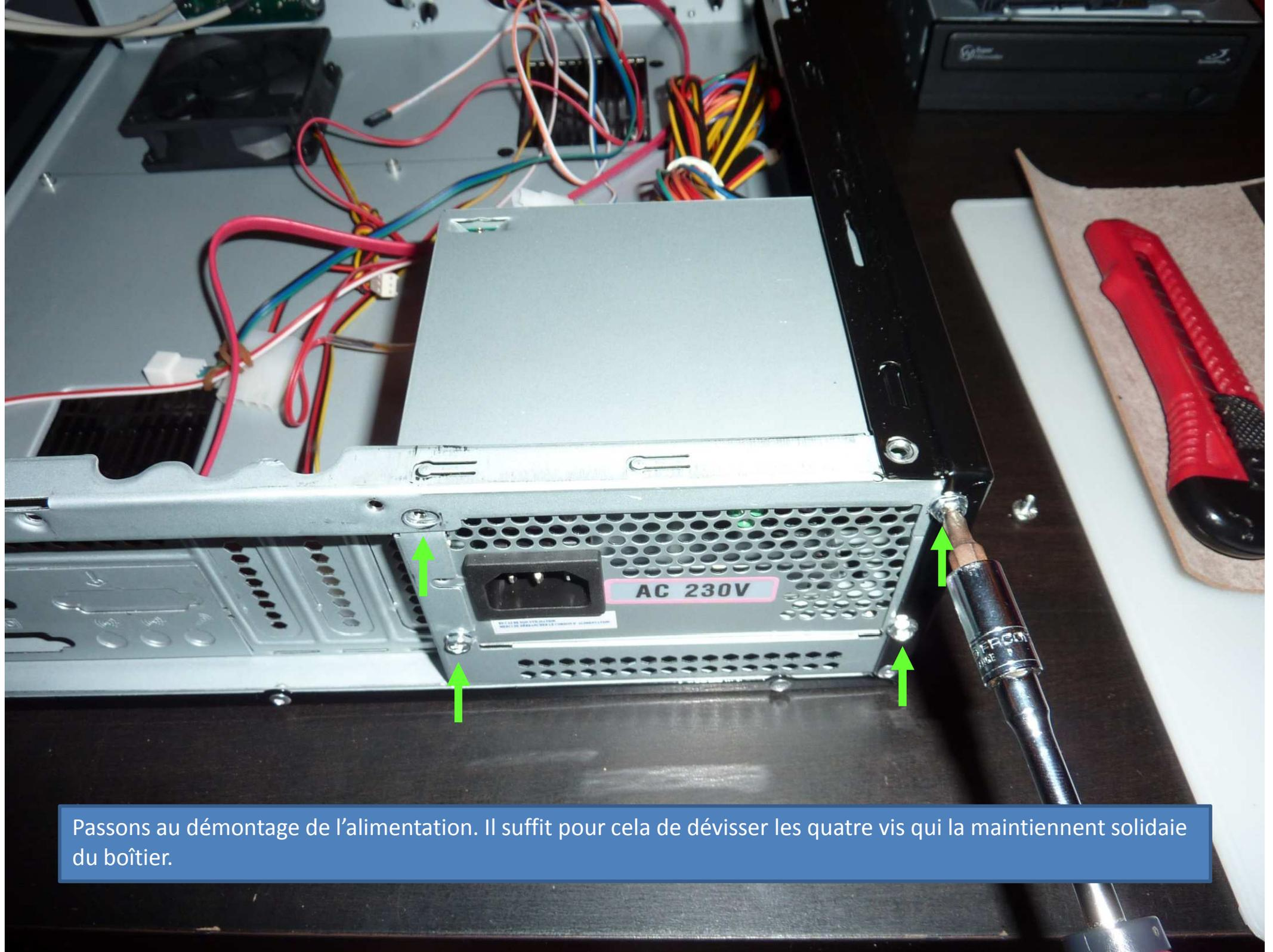
Passons au démontage de l'alimentation. Il suffit pour cela de dévisser les quatre vis qui la maintiennent solidaiie du boîtier.
