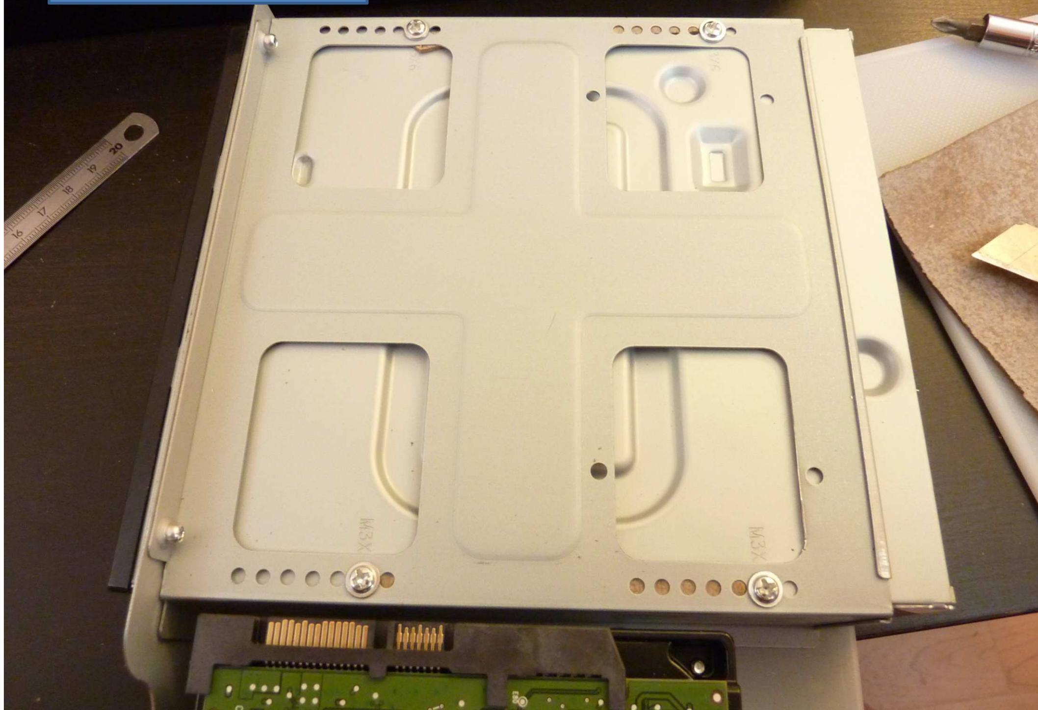
Remplacez la cage des lecteurs dans le boîtier et conservez-la dans cette position pour raccorder les nappes de données et d'alimentation.
