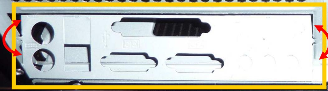
Dégagez ensuite tous les câbles de manière à pouvoir travailler tranquillement dans le boîtier sans être gêné. Ceci fait, faites pivoter la façade arrière du boîtier, d'avant en arrière en faisant attention de ne pas vous couper, pour la détacher la remplacer par celle fournie avec la carte-mère. C'est un travail fastidieux sur ce boîtier, mais pas moyen d'y couper. Attention aussi à ne pas détériorer la peinture noire!
